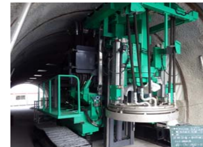
廃棄体を回収するための緩衝材除去装置
