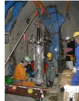
溶接部腐食試験装置の設置作業
