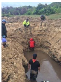
パラワン島のNAサイトでの粘土層のトレンチ調査
