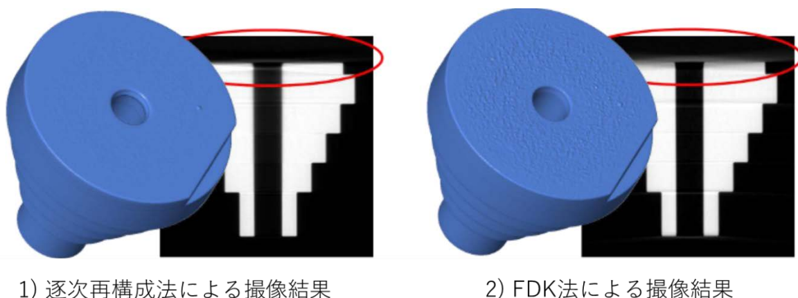
図23 アルミ製ステップシリンダにおけるコーンビームアーチファクトの現状と低減
