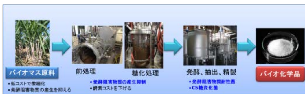
図③-4-1-1. バイオマスを原料としたバイオ化学品合成プロセス
