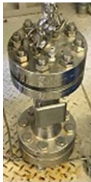
①膜エレメントを組み込んだ ステンレス製ハウジング
