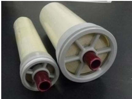
①膜エレメント (左 2inch、右 4inch、L200mm)
