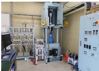
亀裂せん断滑り実験装置(左)と加圧注水シミュレーション結果(右)
