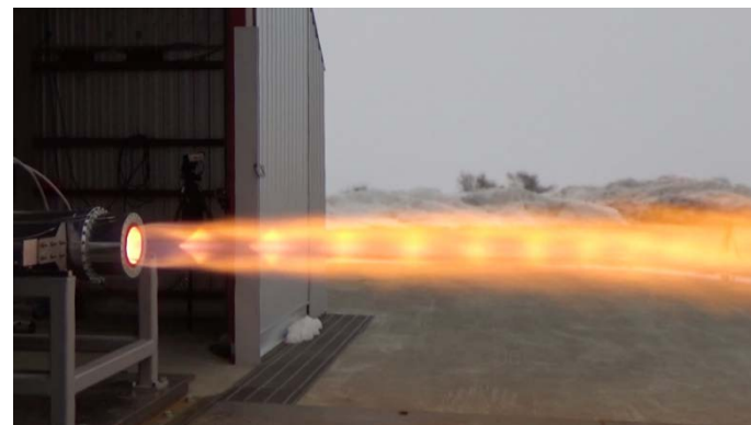
推力10 kN 級エンジンの燃焼試験
