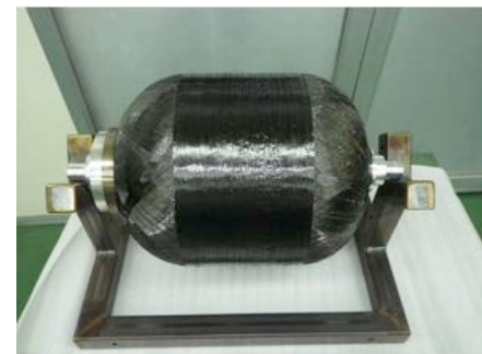
CFRTPによる圧力容器形状の成形品
