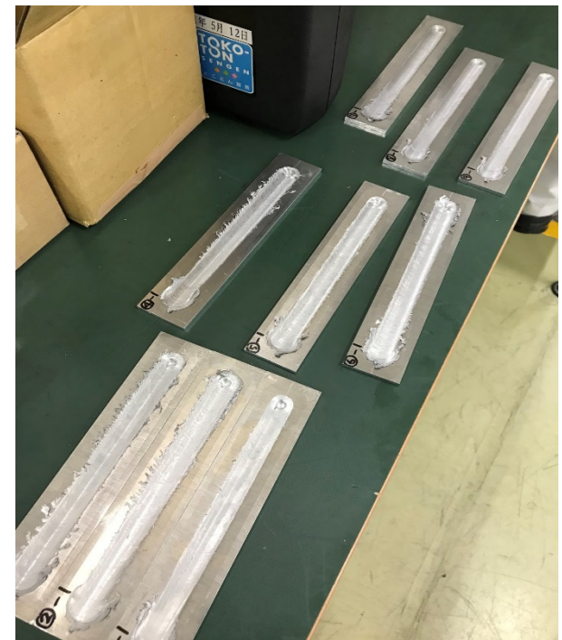
タンクの製造方法として検討している FSW(摩擦攪拌接合)の試験片
