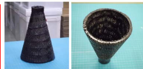
試作したRTM成形品
