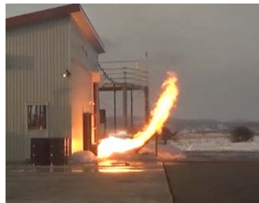
ガス発生器の燃焼試験
