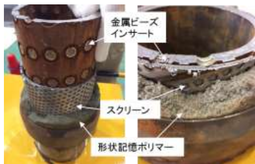
形状記憶ポリマーを使用した3重防護の出砂対策装置を耐久性を確かめるための実験に供した様子。
