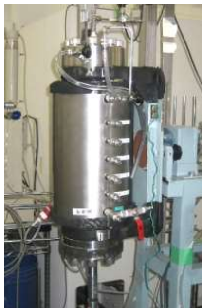
図 小型実験装置(今回実験で使用) (試料寸法: \Phi 5\text{cm} \times 10\text{cm} 、1次元流れの透水実験用)
