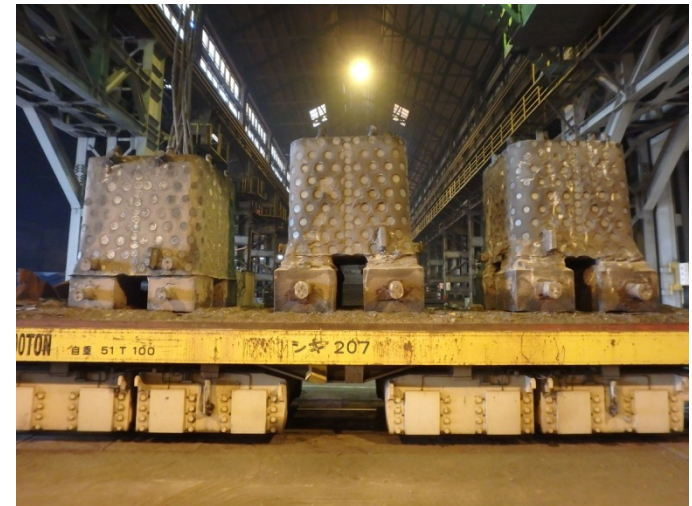
図2 クリアランス金属を用いた金属容器の試作結果
