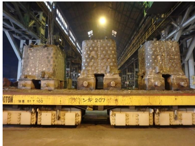
図 2. B - 7 クリアランス金属を用いた金属容器の試作結果
