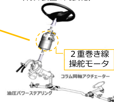
自動操舵装置の2重化（制御装置の冗長化）
