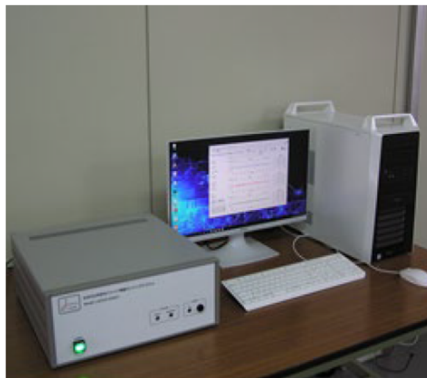
図2:本事業で開発した光ファイバ計測システム
