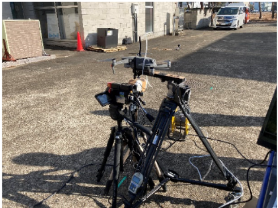
図3 赤外線装置上部にドローン風を起こし撮影
