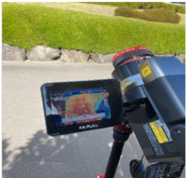
図7 赤外線汎用機（地上設置）による熱画像の撮影
