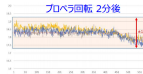
図①-3 黒体板の測定温度ラインプロファイルの時間変化
