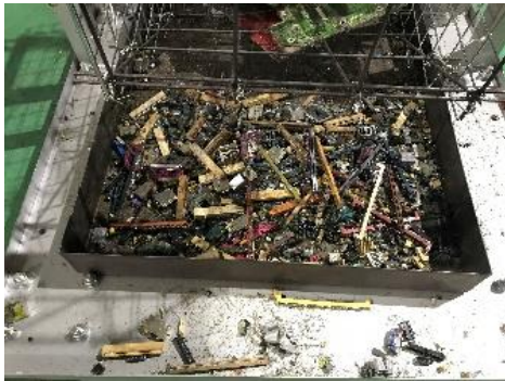
図2 加熱装置の外観（上）とスケールアップ試験で基板から剥離された素子類（下）
