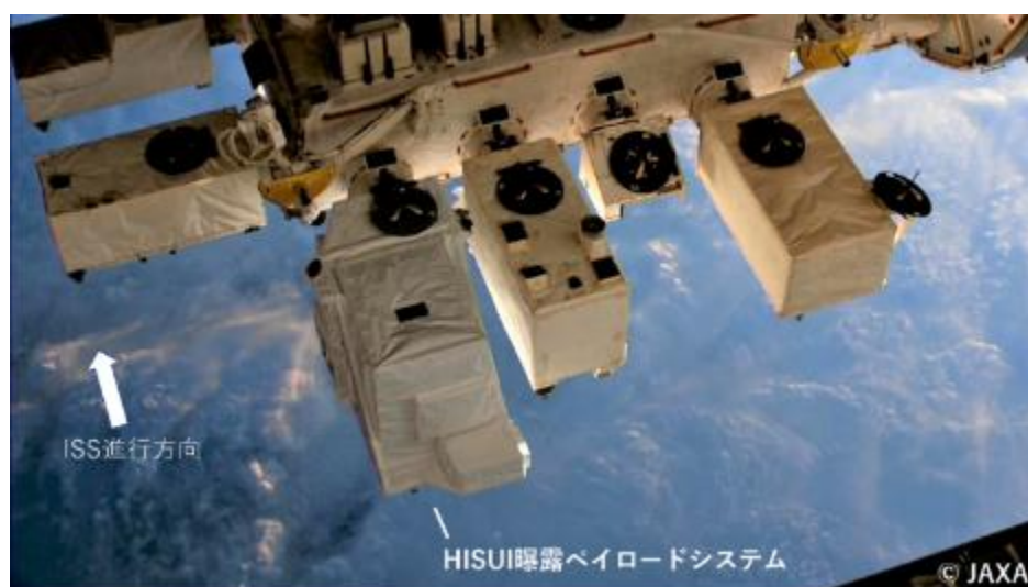
図 2-②-6 JEM 曝露部に移設された HISUI
