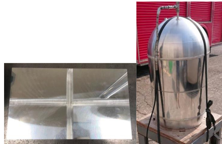
FSW技術 製造と耐圧試験
