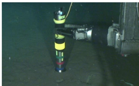
地中温度計の設置
