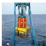
■遠隔操作無人探査機(ROV) 機能:船上からの遠隔操作により海中を自由に動き回ることができ、Hi-Visionカメラによる海底観察や、マニピュレーターによるサンプリング作業等が可能 稼働水深:3,000m
