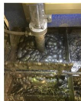
選鉱試験設備と浮遊選鉱の様子
