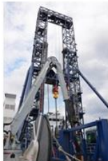
■船上設置型掘削装置 機能:船体中央の開口部(ムーンプール)からドリルパイプを海底に降ろして掘削する装置 稼働水深:2,000m 掘削能力:400m
