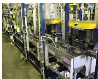
選鉱試験設備と浮遊選鉱の様子
