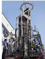
■海底着座型掘削装置(BMS20M) 機能:海底に着底し、掘削する装置。光・動力複合ケーブルでつながっており、船上からの操作で掘削が可能。主にコバルトリッチクラストの掘削に使用。 稼働水深:6,000m 掘削能力:20m
