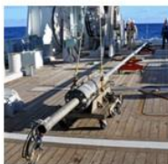
■ピストンコアラ 機能:筒状の採泥器で、海面近くまでケーブルで吊り下げ、海底近くで落下させ堆積物を採取する装置 採泥能力:20m
