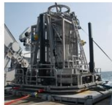
■海底着座型掘削装置(BMS20M) 機能:海底に着底し、掘削する装置。光・動力複合ケーブルでつながっており、船上からの操作で掘削が可能。主にコバルトリッチクラストの掘削に使用。 稼働水深:6,000m 掘削能力:20m
