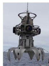
■パワーグラブ 機能:6本の鉄の爪を油圧で開閉し、海底の試料を採取する装置。光・動力複合ケーブルでつながっており、カメラで観察しながら試料採取が可能 稼働水深:6,000m
