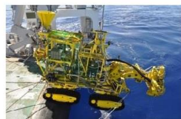
海中に投入される集鉱試験機
