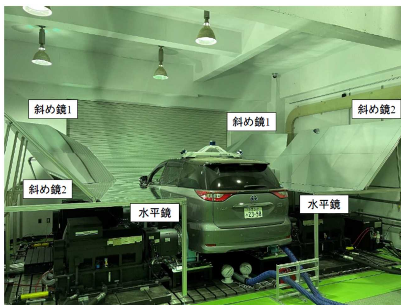
試験設備に設置した鏡架台
