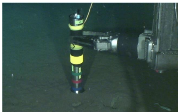
地中温度計の設置
