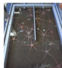
大型水槽による曝露試験：濁度・メタン・硝酸素など
