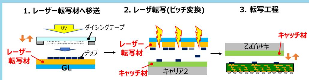
※ マストランスファー：一度に多量のチップを基板上に移送・配置する技術
