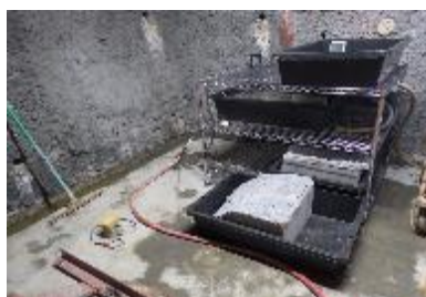
実地下水を用いた暴露試験
