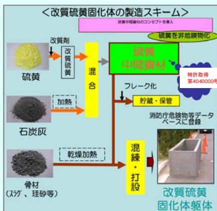
硫黄固化体製造プロセスの要素技術
