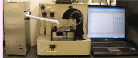
送気ユニット システム本体 制御用PC
