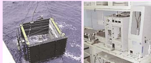
投入中の鉛直多層ネット
