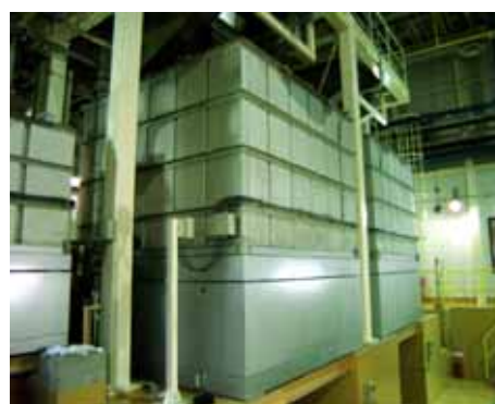
図5 国家標準校正設備（秤量タンク）
