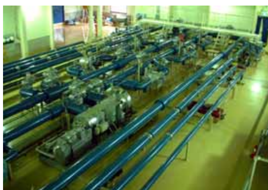
図4 国家標準校正設備（テストライン）
