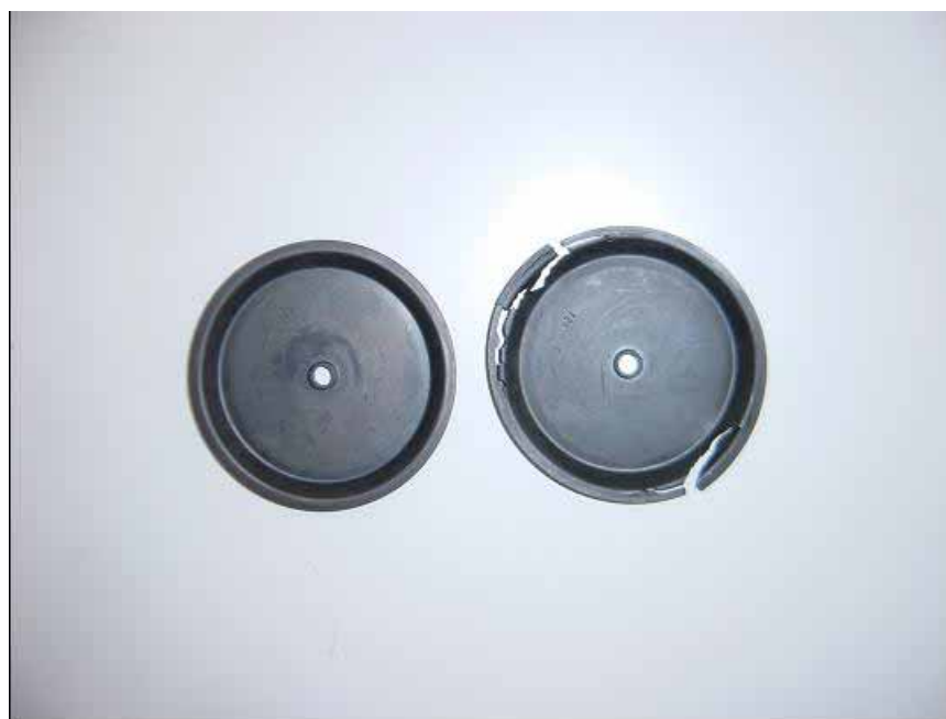
図 3.1.2.5 正常品 (左) とオゾン劣化品 (右)
