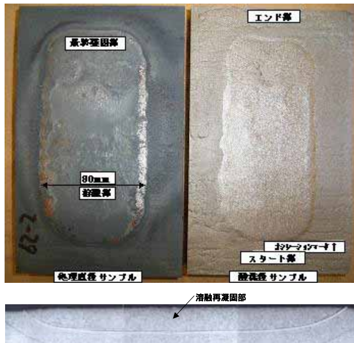
図 3-1-1. プラズマによる鋳片表層溶融状況
