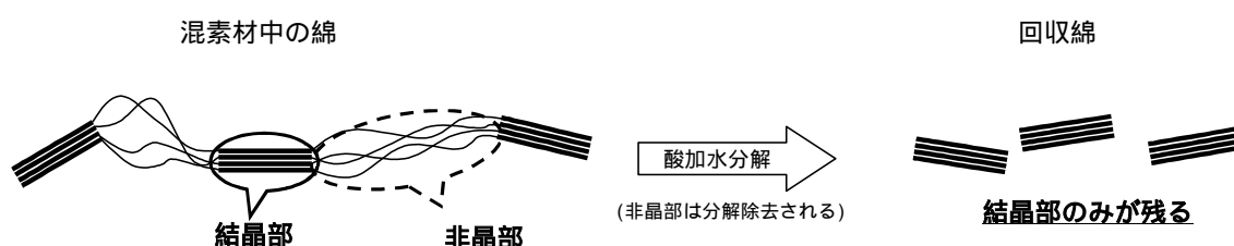
図2 - 1 . 綿（セルロース）の加水分解モデル図
