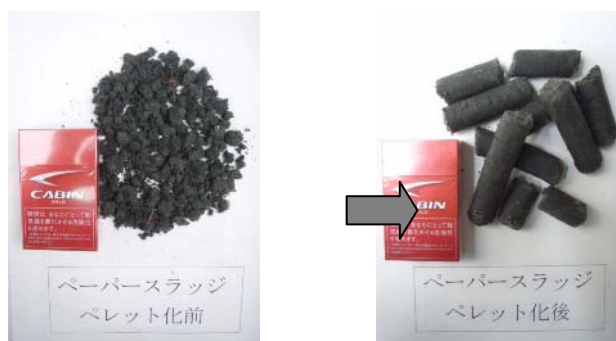
図 1 2 ペーパースラッジのペレット化（ 20mm × 40mm ）
