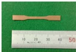
打抜き試料外観
