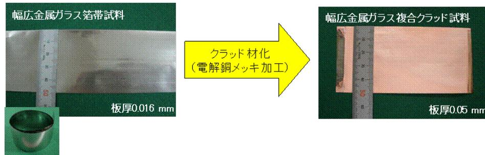
図③-3 Fe基金属ガラス薄帯試料とメッキ層を形成した複合クラッド材外観
