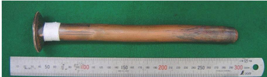
図③-4 押出固化成形体の外観
