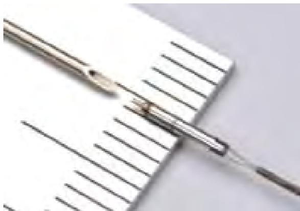
図②-11 直径 0.9mm ギヤードモータ
