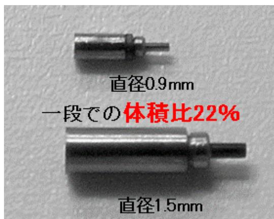
図②-5 試作ギヤヘッドのサイズ比較（一段）
