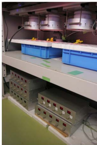
図(1)-5-1 製作した植物環境ジェネレータ（10台製作）
