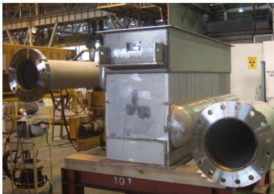
再生熱交換器本体
