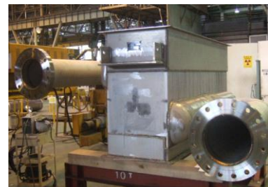
再生熱交換器本体
