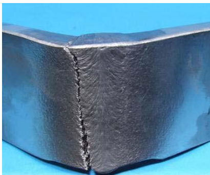
図 注 1-1 曲げ試験で見出された溶接割れ
