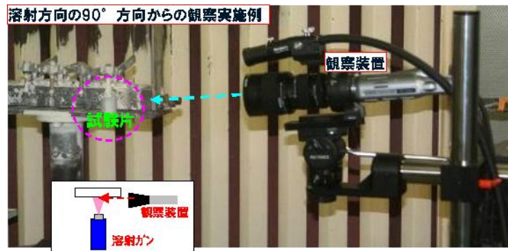
図7 溶射状況の高速カメラ撮影
