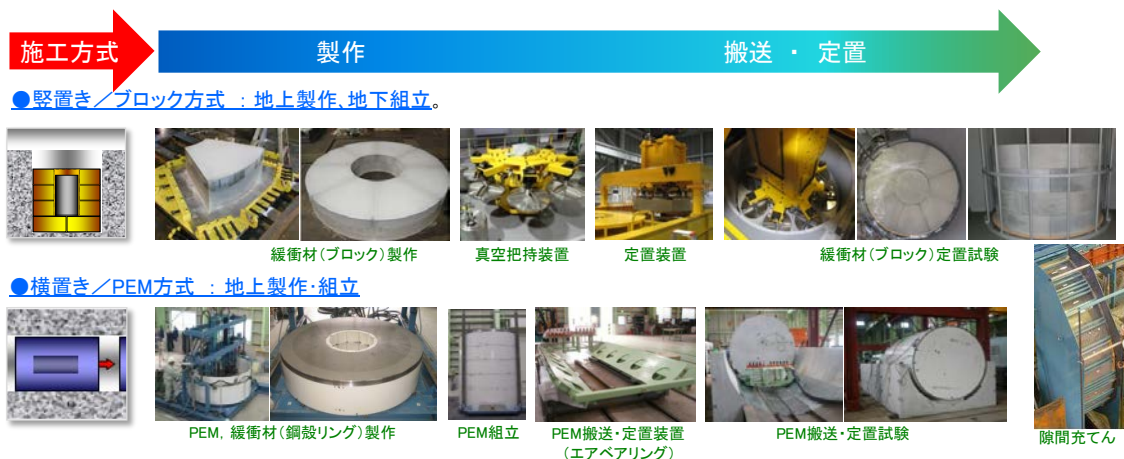
図3-44 遠隔操作技術高度化開発／ (搬送・定置技術に関する成果の一例：緩衝材の搬送・定置システム案)
