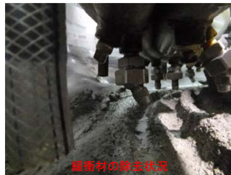
図3-56. 塩水噴射・スラリー吸引部のプロトタイプによる性能試験
