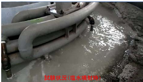
図3-56. 塩水噴射・スラリー吸引部のプロトタイプによる性能試験
