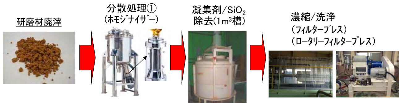
図 3-2 化学的処理工程の流れ
