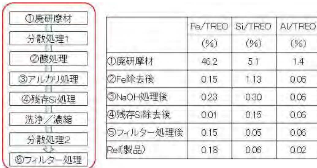
図 3-12. 不純物除去フロー及び各工程後の不純物品位
