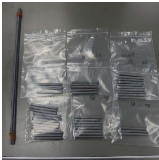
図 2 - 1 2 . 焼結後の押出丸棒
