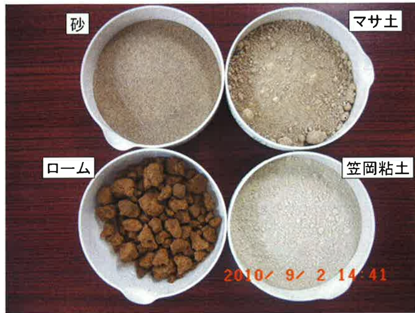
図-3-1-2(3)-1. 浄化試験用土壌写真（乾燥後）
