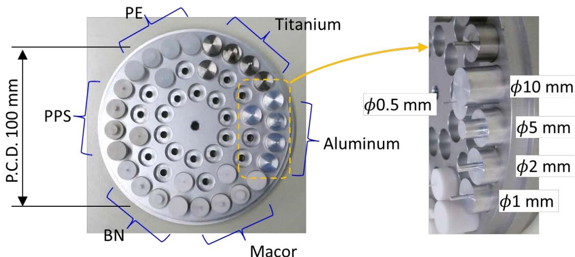
図18 コントラスト分解能ゲージの外観
