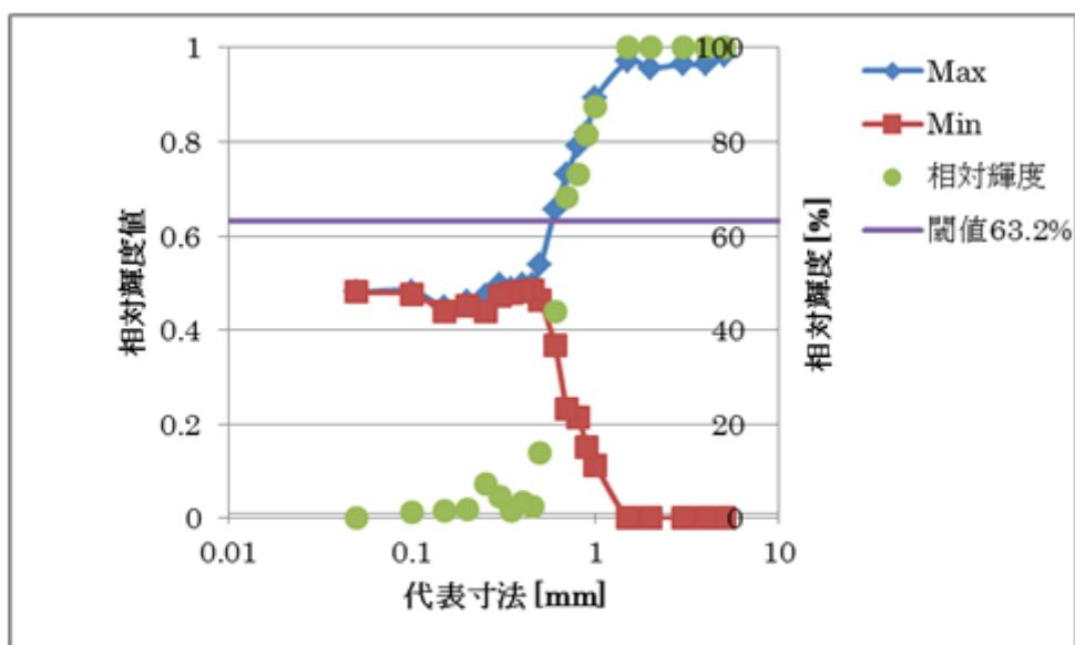
続いて本研究により開発した高エネルギー高分解能 X 線 CT 装置に適用したところ、 $0.1 \text{ mm}/0.1 \text{ mm}$  のライン・アンド・スペースを解像することができた。この性能は、撮像視野  $\Phi 300 \text{ mm}$ において  $0.1 \text{ mm}$  の分解能をもつことを示しており、MeV クラスのエネルギーをもつ既存の高エネルギーX 線 CT の中では、世界的に極めて突出した高い性能を有していることを支持している。
