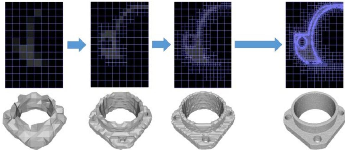
図22 4 分木分割による適合的逐次再構成のイメージ
