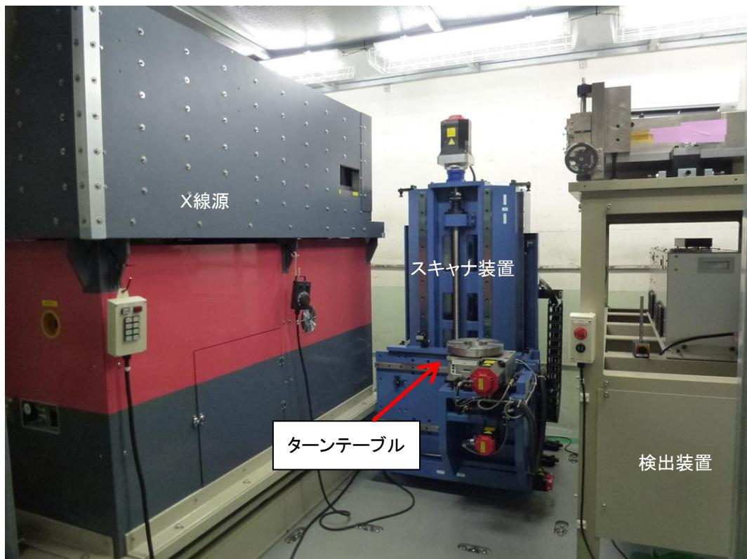
図 3 高エネルギー高分解能 X 線 CT 装置の概観写真
