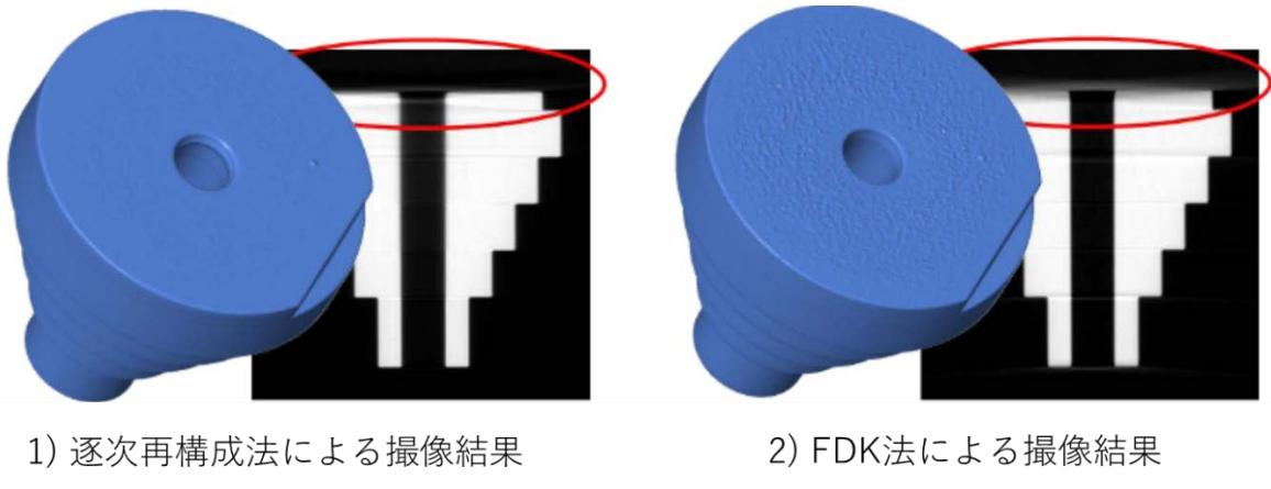
図23 アルミ製ステップシリンダにおけるコーンビームアーチファクトの現状と低減
