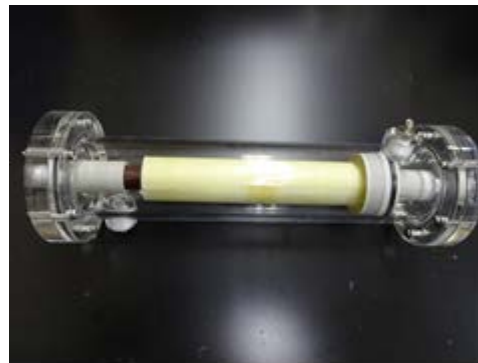
②ハウジング中に組み込んだ膜エレメントのイメージ (透明なアクリル製ハウジングを使用)
