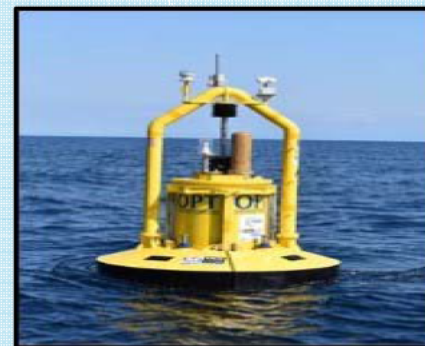
機械式波力発電 （提供：三井造船）
