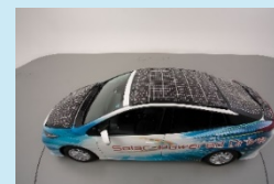
狭い面積でも十分な駆動力が得られる車載用太陽電池モジュール（出典：トヨタ自動車株式会社HP）
