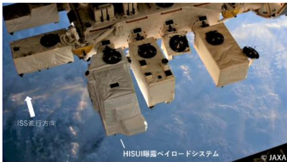
図2-②-6 JEM曝露部に移設されたHISUI
