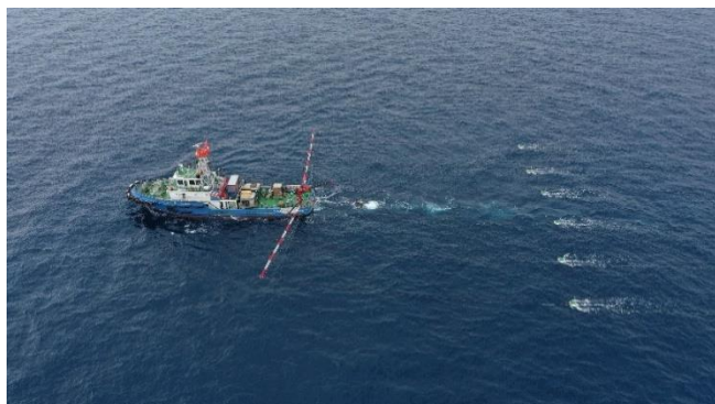
高分解能三次元地震探査
