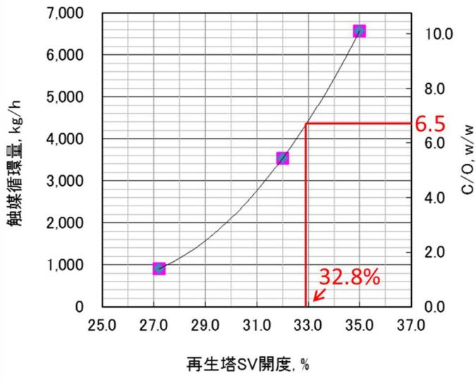
図 4－14 再生塔 SV 開度と触媒循環量の関係
