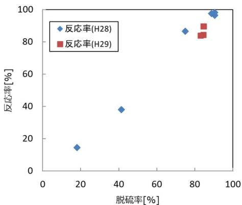
図 6-1-1 硫黄化合物のコア反応率と脱硫率
