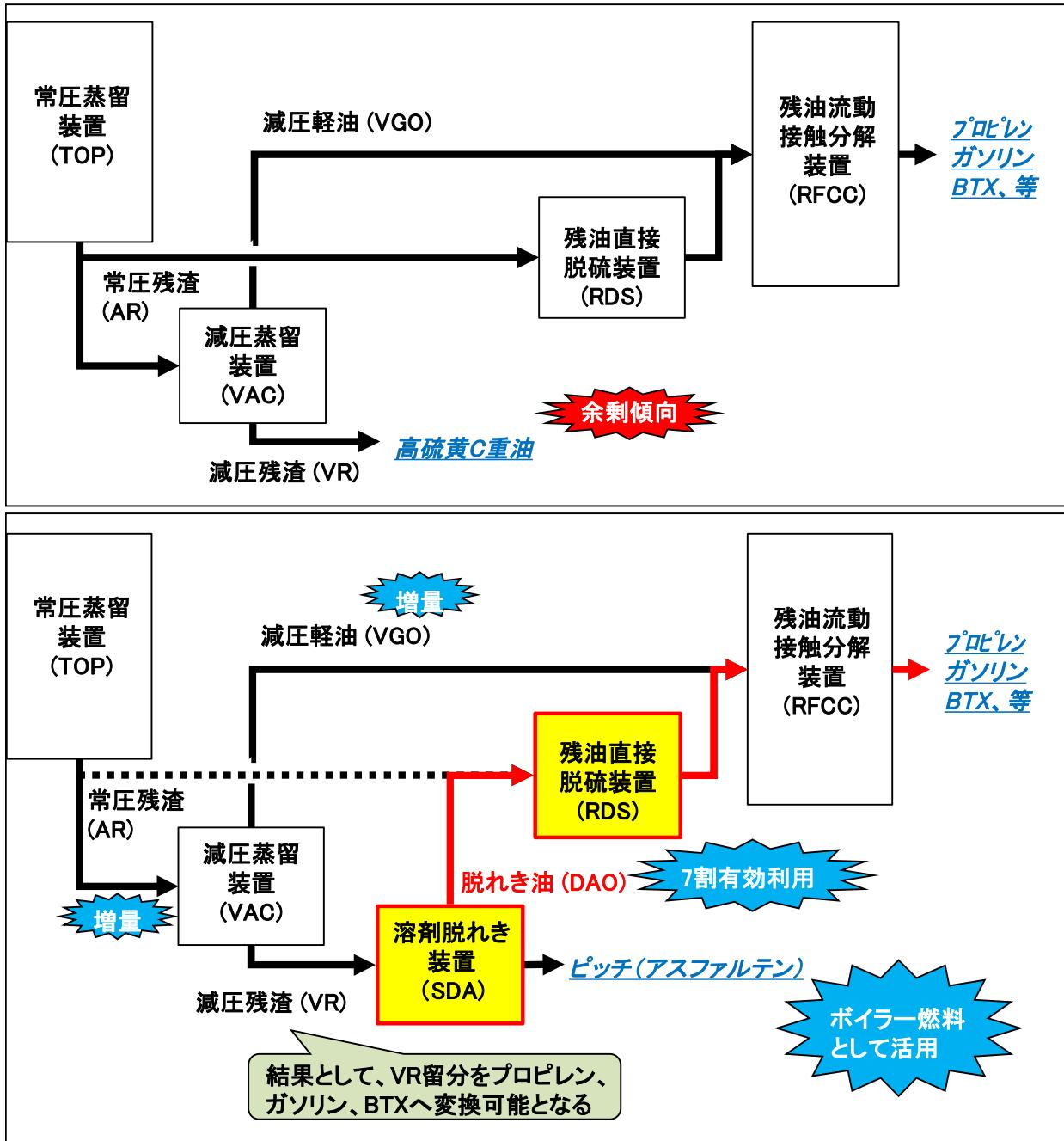
図4-25 従来プロセス（上）と開発プロセス（下）の比較
