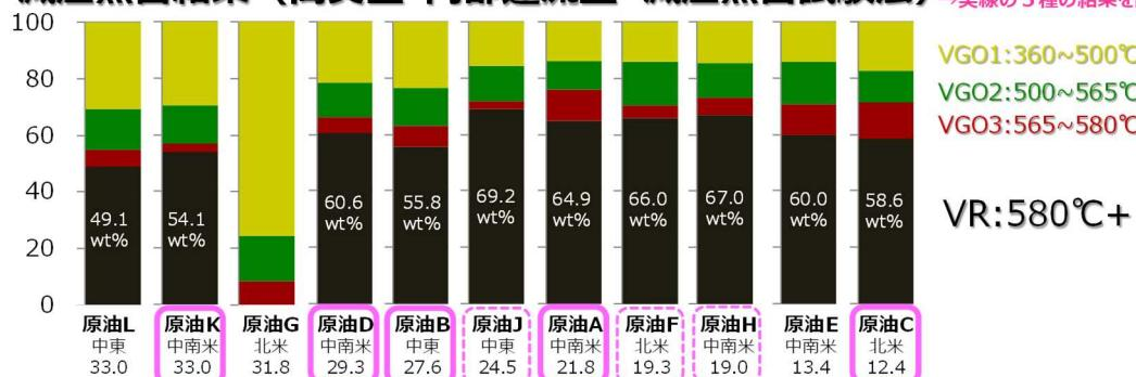
図6-1 高真空・内部還流型 減圧蒸留方法による高沸点領域における留分分布
