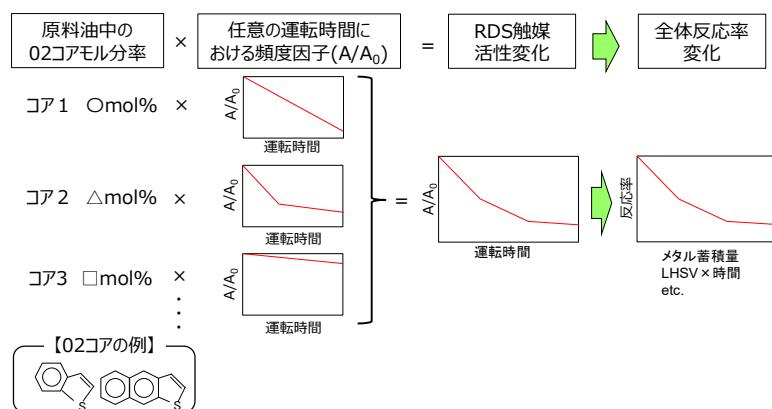
図 6-1-2 RDS 触媒の劣化度予測手法
