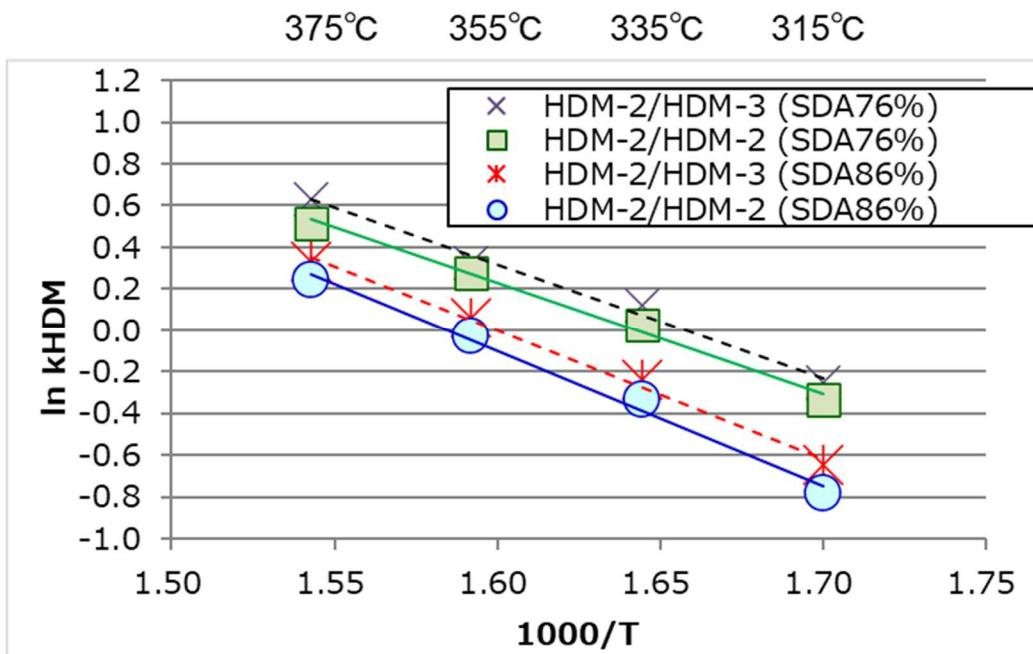
図4-39 抽出率の異なるDAOの反応性比較（HDIM反応）
