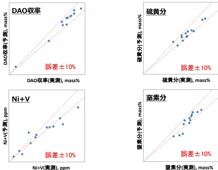
図 4－20 DAO收率・性状の実験値とSDAモデルによる予測値の比較
