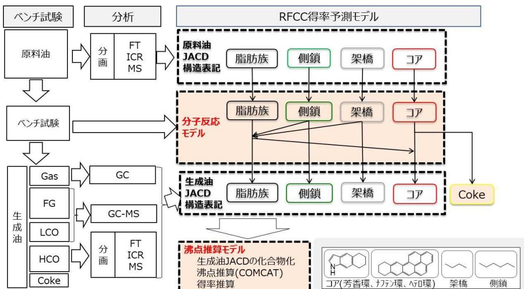
図 6－6 RFCC 得率予測モデルの概要
