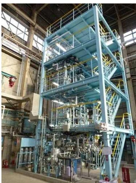
図 4-11 SDA 実験装置の外観
