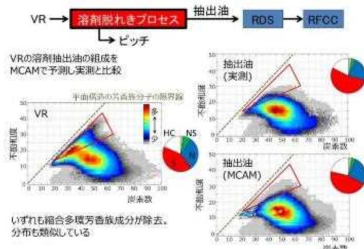
図6-14 減圧残油溶剤脱れきプロセスの抽出物の成分予測
