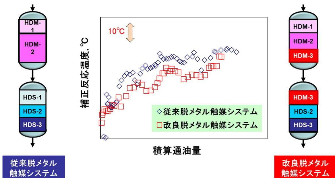
図4-34 開発脱メタル触媒システムによる実機検証
