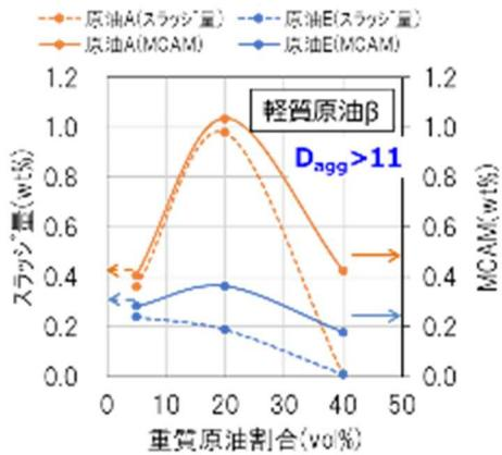
図 6－5 軽質原油  $\beta$  と重質原油(A、E)を混合した時MCAMによるスラッジ予測結果
