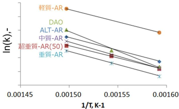
図 4-15 RDS 反応性結果
