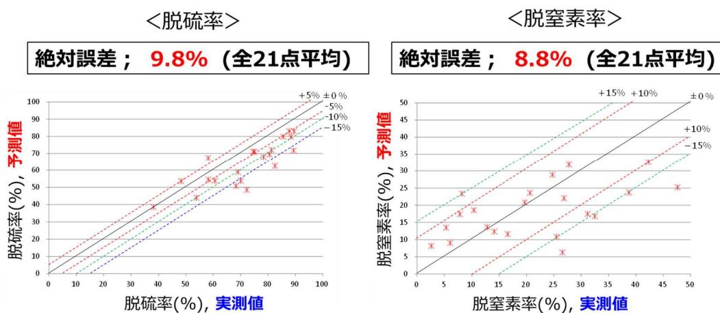
図6-2 ARの脱硫率及び脱窒素率の予測モデル検証結果
