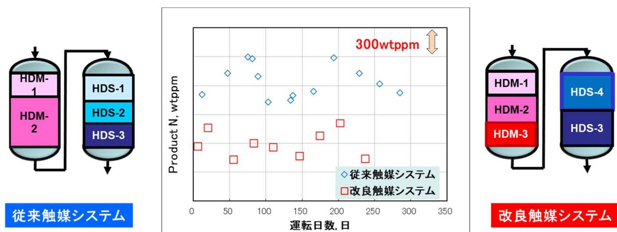
図4-35 開発触媒システムによる実機検証（生成油中窒素濃度の推移）
