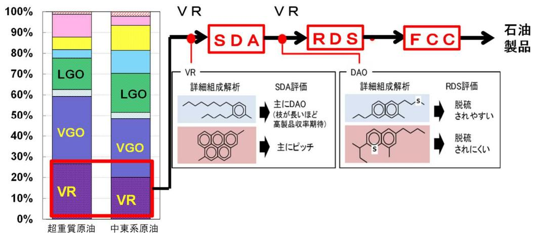
図4-9 詳細組成構造解析のイメージ
