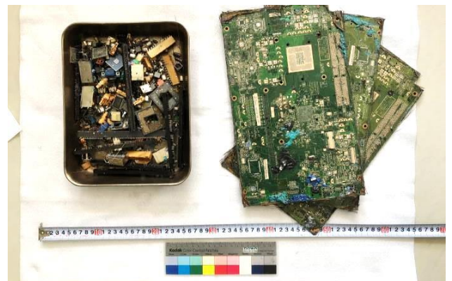
図5 加熱後の基板および剥離した素子類
