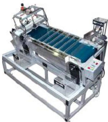
図 12 傾斜コンベア
