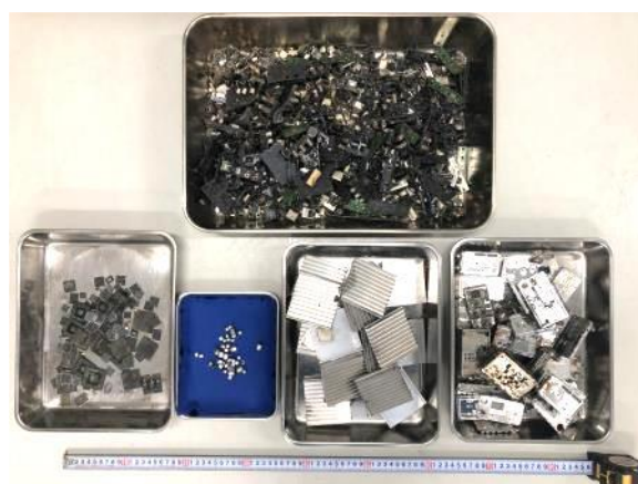
図8 試験後の家電由来基板（上）と 試験後の基板から剥離された素子類（下）
