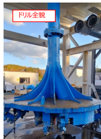
試験用の掘削ドリル： Φ2.65m (商業化時の掘削ドリルΦ7.3mの約1/2.7スケール)
