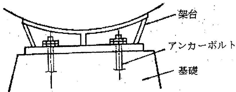
(5) 横置円筒形貯槽の架台の支持間隔（スパン）が5m以上のものにあっては、当該貯槽の遊動側の架台に対し基礎据付面と架台底面との間に次のイ、ロ、ハに定めるすべり板を設けること。
