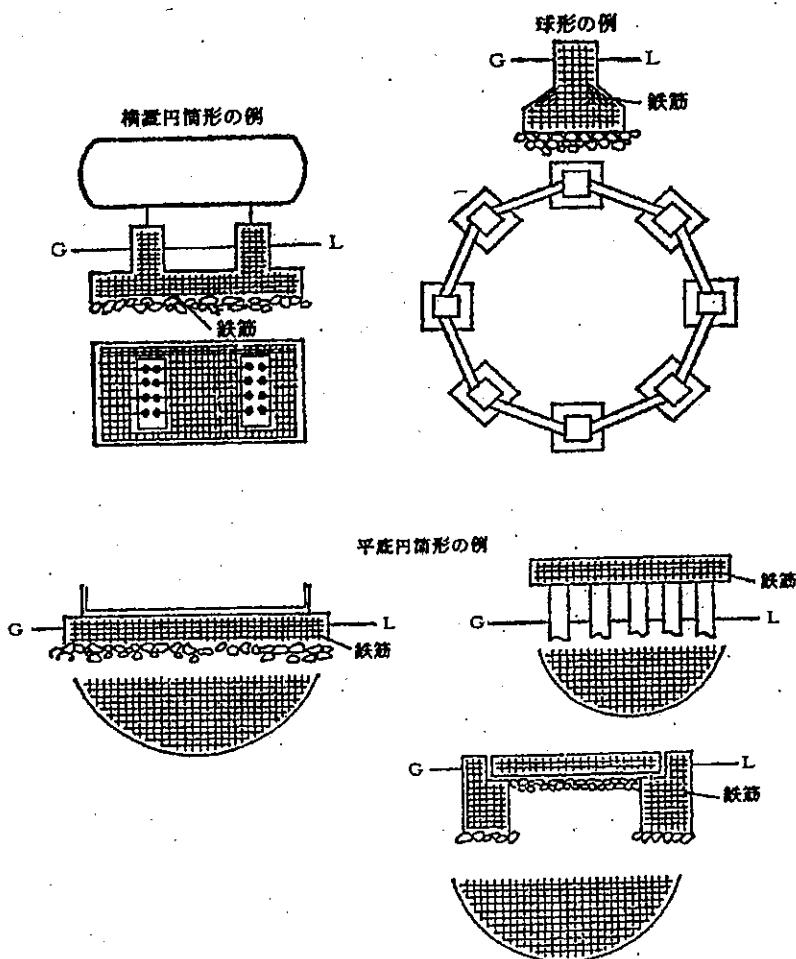
8.2 貯槽を基礎に緊結する方法は、次の基準の例によるものとする。
