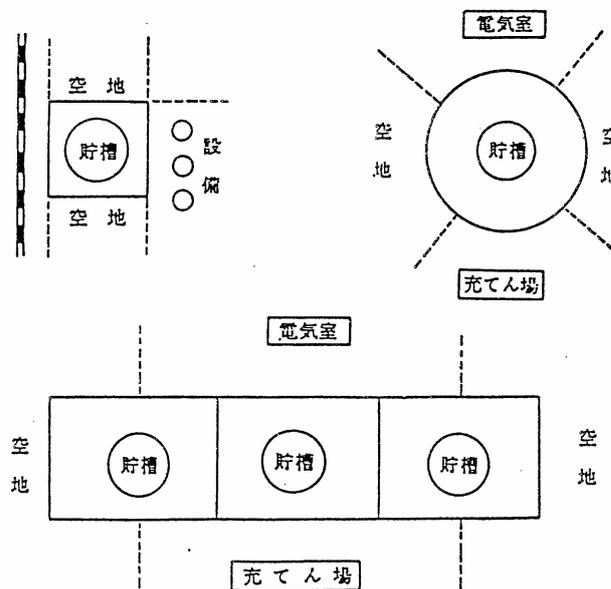
2. 防液堤に関する一般高圧ガス保安規則関係例示基準5及び液化石油ガス保安規則例示関係基準10中集合防液堤に複数の貯槽を設置する場合の防液堤の容量についての特例を定めているが、この場合において、これらの基準2の項(容量)の表備考により間仕切り防液堤が必要であり、この限りにおいて、この間仕切り防液堤自体が一つ一つの貯槽の防液堤とみなされるものである。この場合において、既に間仕切りが設置されており、当該間仕切りがおおむね備考に定める容量に応じて設けられている場合には、当該間仕切りをもって基準に適合する間仕切りとみなす。
