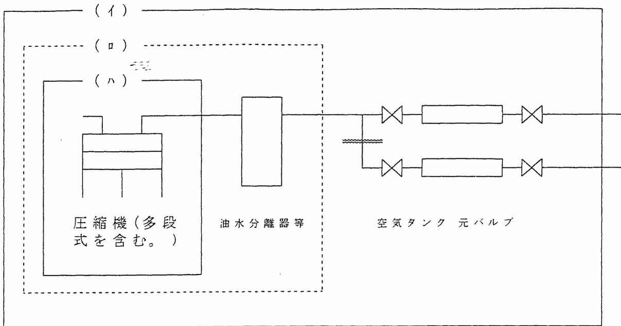
「温度35度においてゲージ圧力5メガパスカル」とは、空気タンクを有する圧縮装置(上図の(イ)のケース)については、空気タンク内の圧力を温度35度における圧力に換算した圧力とし、空気タンクを有しない圧縮装置(上図(ロ)又は(ハ)のケース)については、圧縮機の吐出し圧力を温度35度における圧力に換算した圧力とする。
