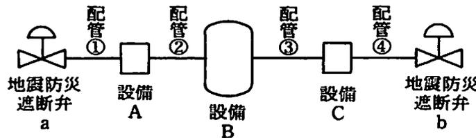
内容積＝地震防災遮断弁 a の内容積の 1/2＋配管①の内容積＋配管②の内容積＋配管③の内容積＋配管④の内容積＋地震防災遮断弁 b の内容積の 1/2
