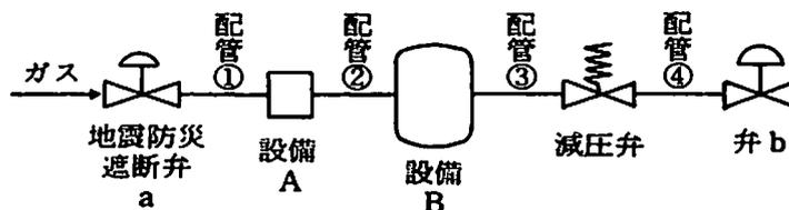
内容積＝地震防災遮断弁 a の内容積の 1/2＋配管①の内容積＋配管②の内容積＋配管③の内容積＋減圧弁の内容積の 1/2
