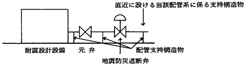
「十分な可とう性を有していること」とは、耐震設計構造物と当該耐震設計構造物に係る配管の支持構造物の間に地盤変状に伴う相対変位が生じた場合に、当該相対変位量に対して当該配管が十分な変位吸収能力を保有している設計を講じていることをいう。
