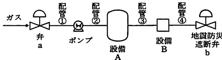
内容積＝配管②の内容積＋配管③の内容積＋配管④の内容積＋地震防災遮断弁 b の内容積の 1/2
