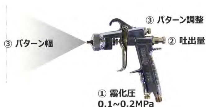
付図 3 霧化圧、吐出量、パターン幅の調整
